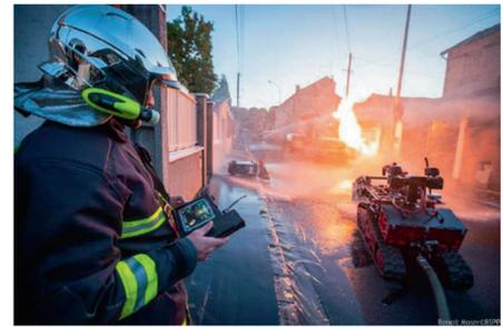
Figure 1 : le robot Colossus en intervention
