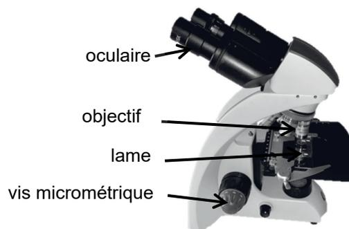
Figure 1. Photographie d'un microscope
