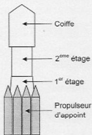
Figure 4. Schéma de la constitution de la fusée.
