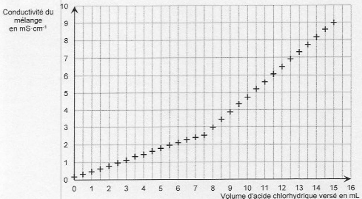
Figure 2. Courbe du titrage de la solution d'ammoniac S<sub>4</sub> par une solution d'acide chlorhydrique de concentration molaire égale à 1,0 mol·L<sup>-1</sup> suivi par conductimétrie.
