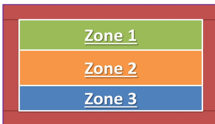
Rien ne doit être disposé au bord de la paillasse, ici symbolisé par la partie rouge. Cela permet d'éviter toute chute.
