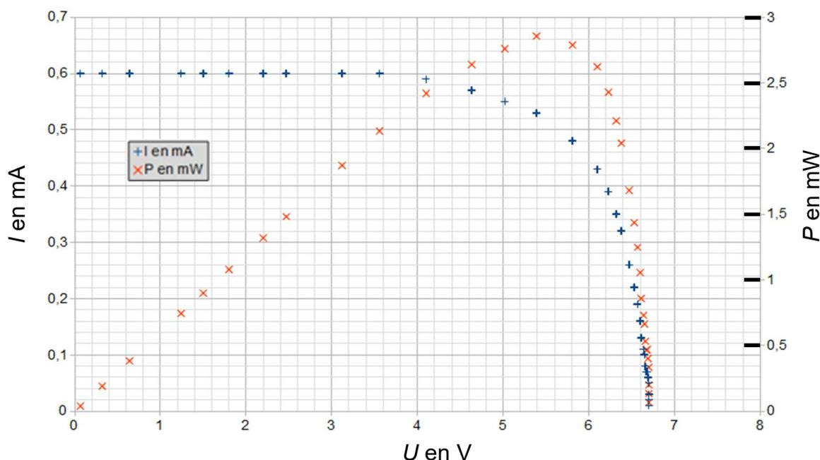
**6.** Déterminer graphiquement, sur **le document réponse DR3 à rendre avec la copie**, les valeurs de la puissance électrique maximale  $P_{\max}$ , de la tension  $U_{P_{\max}}$  et de l'intensité  $I_{P_{\max}}$  du panneau photovoltaïque lorsque la puissance électrique délivrée par ce dernier est maximale. Vérifier la cohérence de ces trois valeurs.
