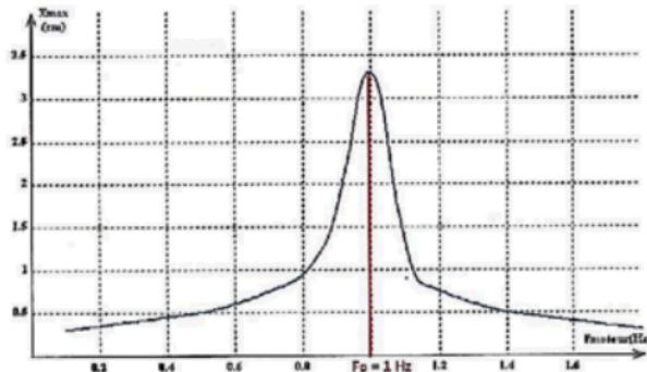
a - Lorsque la fréquence du moteur correspond à la fréquence propre du système on a un pic d'amplitude : c'est la **résonance**.
