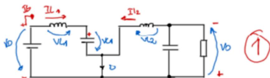
Circuito equivalente em  $t_{on}$  ( $D \cdot t_s$ )
