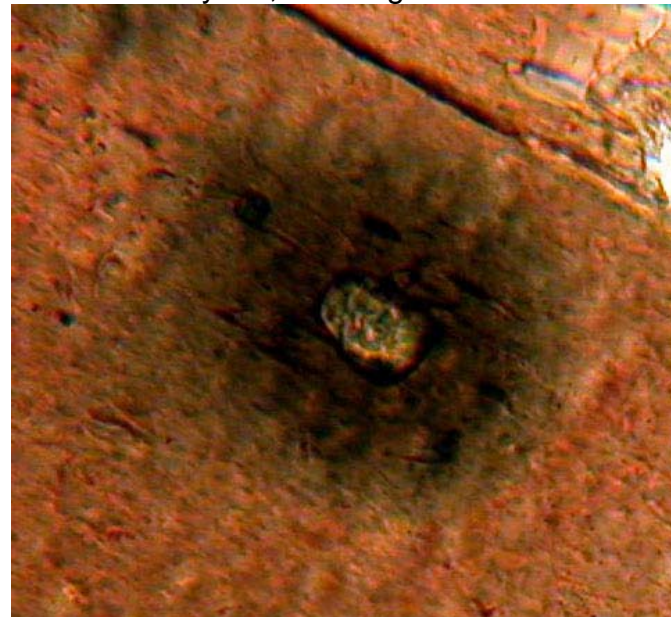
Image 2- Auréole entourant le zircon dans une biotite en lumière polarisée et analysée, au fort grossissement
